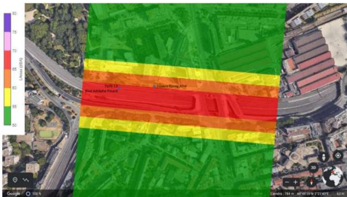
Figure 7 : Impact sonore maximal au passage ( L_{Amax} ), au sol, du VC-2X en phase de survol sur une portion du périphérique –source : dossier
